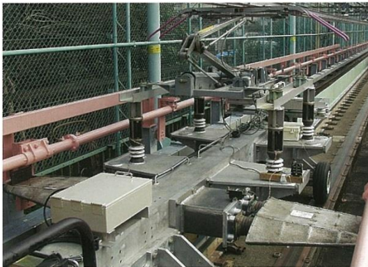
圖 4.4.2-3 集電裝置於測試軌上試驗示意
