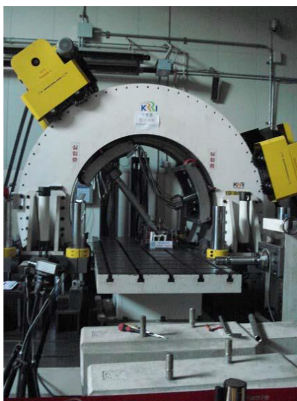
軌道扣件測試設備
