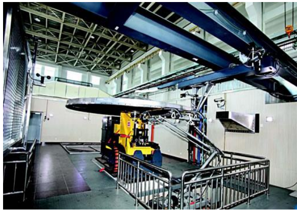
高速集電弓及接觸線關係試驗台
