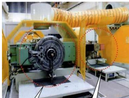
圖 4.4.2-2 煞車性能試驗機示意
