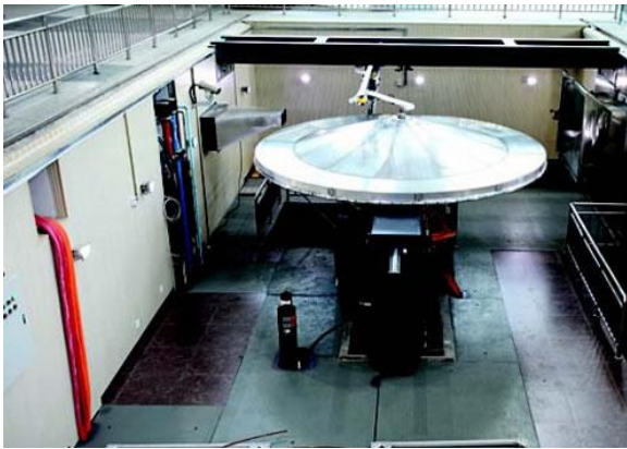
高速集電弓及接觸線關係試驗台
