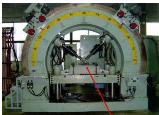
圖 4.4.2-5 軌道扣件性能實驗裝置
