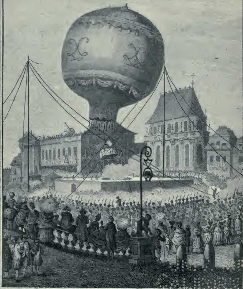
Expérience faite à Versailles, en présence de leurs Majestés et de la Famille Royale, par M. Montgolfier, le 19. Sept. 1783. La Machine Aerostatique avoit 57. Pieds de haut sur 41. de Diametre.
