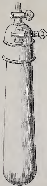
Fig. 4. Récipient qui a servi à la première expérience dite du marteau d'eau .
