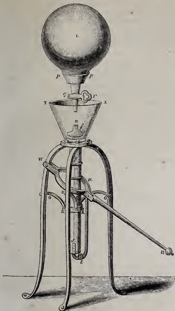
Fig. 3. Première machine pneumatique fonctionnant régulièrement.
