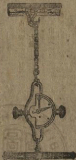
第五圖 背力腿力計測器
