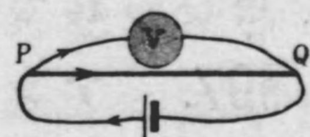
図 97.3 ボルトメーターの原理を説明す
