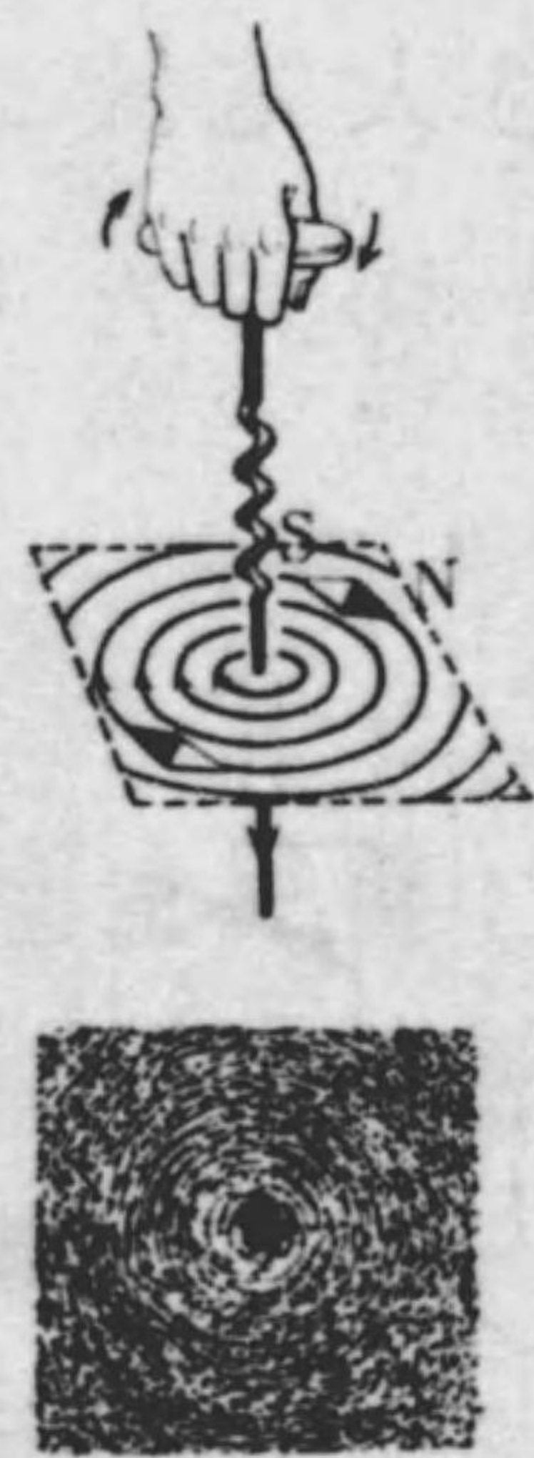
圖 88-1 磁力線の方向と電流の方向
