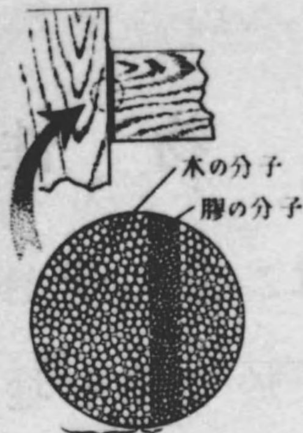
凝集力 附着力 図 12-2 木片を膠にて接着す
