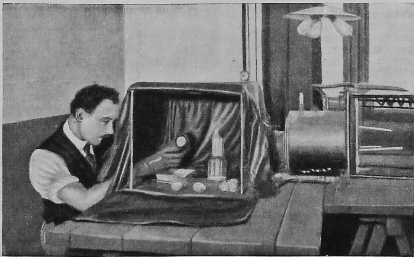
Рис. 1. Аппаратъ для безмикробной жизни; обезпложиваніе вводимыхъ яицъ.
