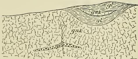
Skizze des kleinen Steinbruchs an der Feldstufe zwischen Hösbach und Feldkahl. **gnk** = undeutlich schieferiger Biotitgneiss (feinkörniger Biotitgneiss) mit einer 10<sup>cm</sup> starken Pegmatitlage **p** und einer Einsackung von Glimmerreichem schieferigem Gneiss **gl**, der seinerseits eine Linse von grobflaserigem Biotitgneiss (**gnk**), etwa 2<sup>m</sup> lang und 1<sup>m</sup> mächtig, einschliesst.
