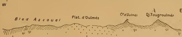
FIG. 5. — COUPE DU PLATEAU GRANITIQUE D'OULMÈS. s, qs, schistes et quartzites paléozoïques; \gamma , ellipse granitique d'Oulmès.
