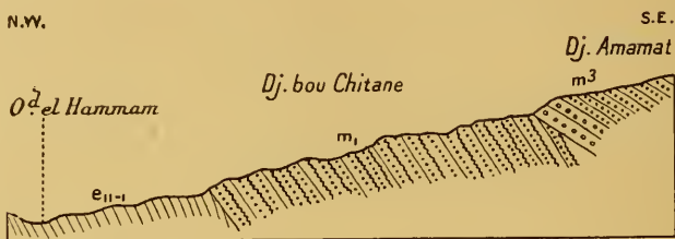
FIG. 3. — COUPE ENTRE L'OUED EL HAMMAM ET LE DJEBEL AMAMAT. e 11-1 , Marnes éocènes ; m 1 , Aquitainien ; m 3 , Poudingues et grès à Ostrea crassissima .
