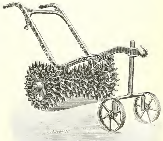
Fig. 89. - Rouleau Crosskill de Souchu-Pinel pour le travail en billons dans les vignes.
