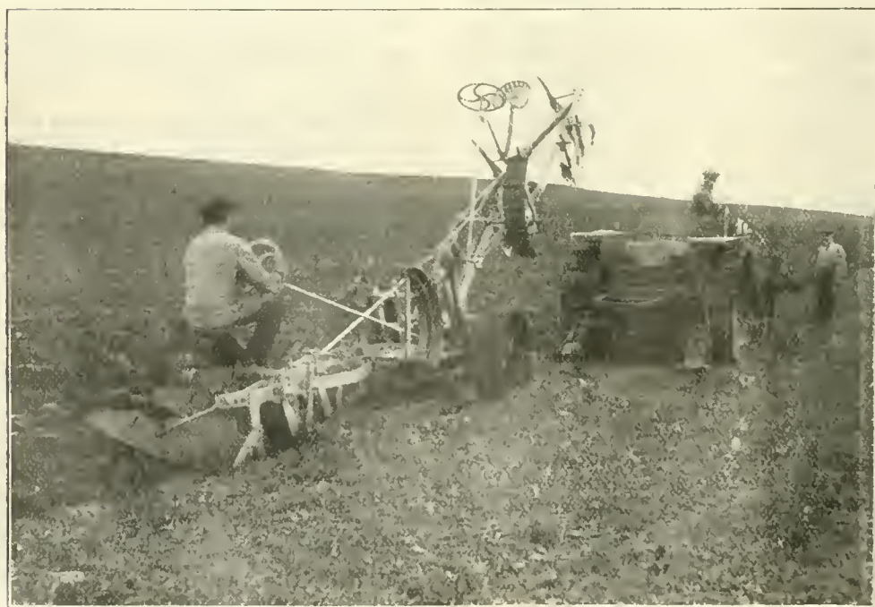
Fig. 106. — Tracteur Bajac. En avant le tracteur et en arrière la charrue balance qu'il remorque.
