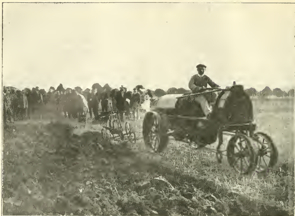
Fig. 105. — Tracteur-toueur de Filtz, attelé à une charrue brabant double.
