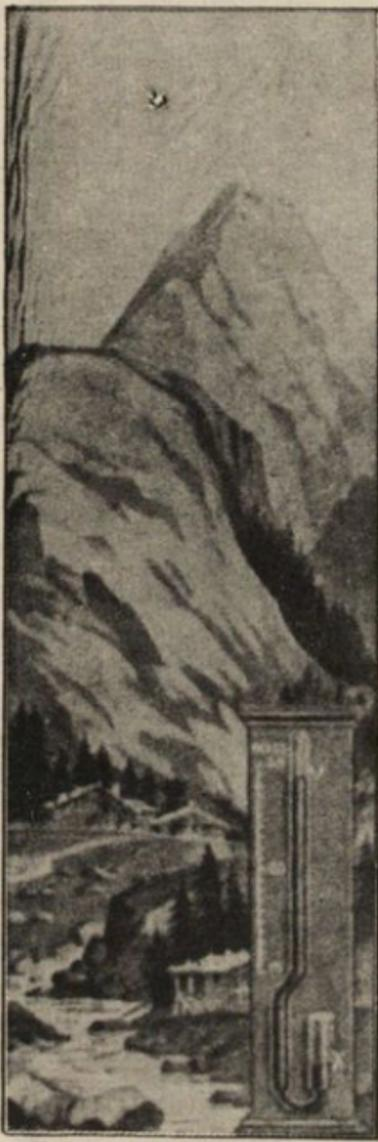
山的高度可用氣壓表測量出來的。第一圖中有一個氣壓表放在二哩的高山上，大氣的壓是在X，就使水銀僅昇到V。將這氣壓表放下來，如第二圖，放在山谷之中，氣壓就重了，水銀就升高了。將這兩個不同的高度，互相比較，就可以測出山的高度來。
