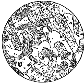
第58圖：花崗岩之顯微鏡圖(×10) 白色部石英，打點部長石， 並線部黑雲母
