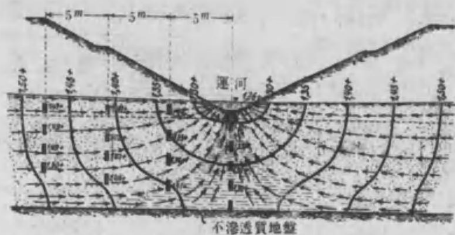
第百十五圖 運河附近ノ帶水層ノ等壓線及地下水流向圖
