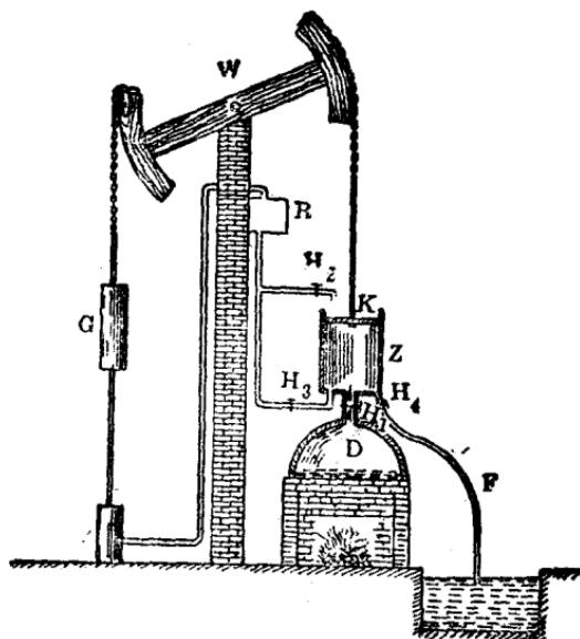
樣一來，蒸汽機工作能力又復增加。圖中所示的H及F即為將Z中水重複放出的機關。一七一〇年時的蒸汽機便是這個狀況。應用此項機器時，必須用兒童司開關H<sub>1</sub>H<sub>2</sub>等之職。
