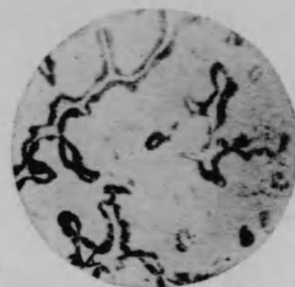
第百三十五圖……磷1.74%炭素0.18%を含有せる鐵(35倍)
