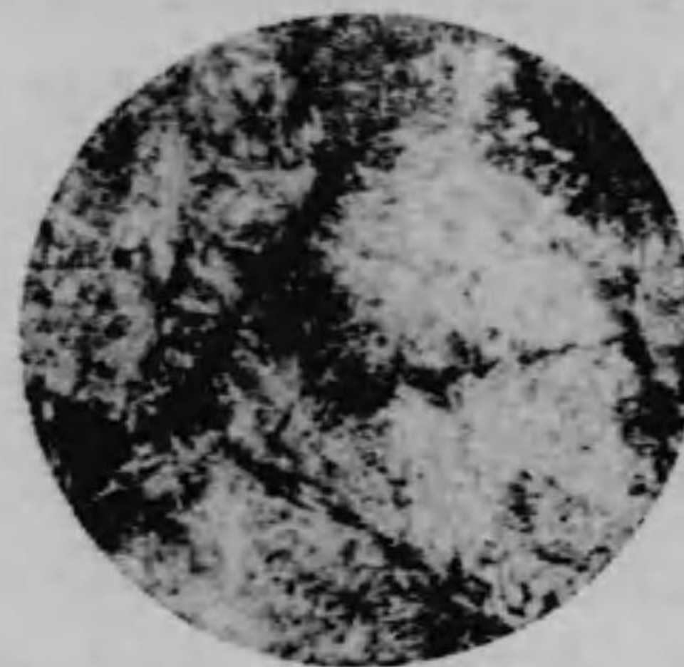
第九十二圖……「ユーテクトイド」の土臺を有せる鑄鐵 (375倍)
