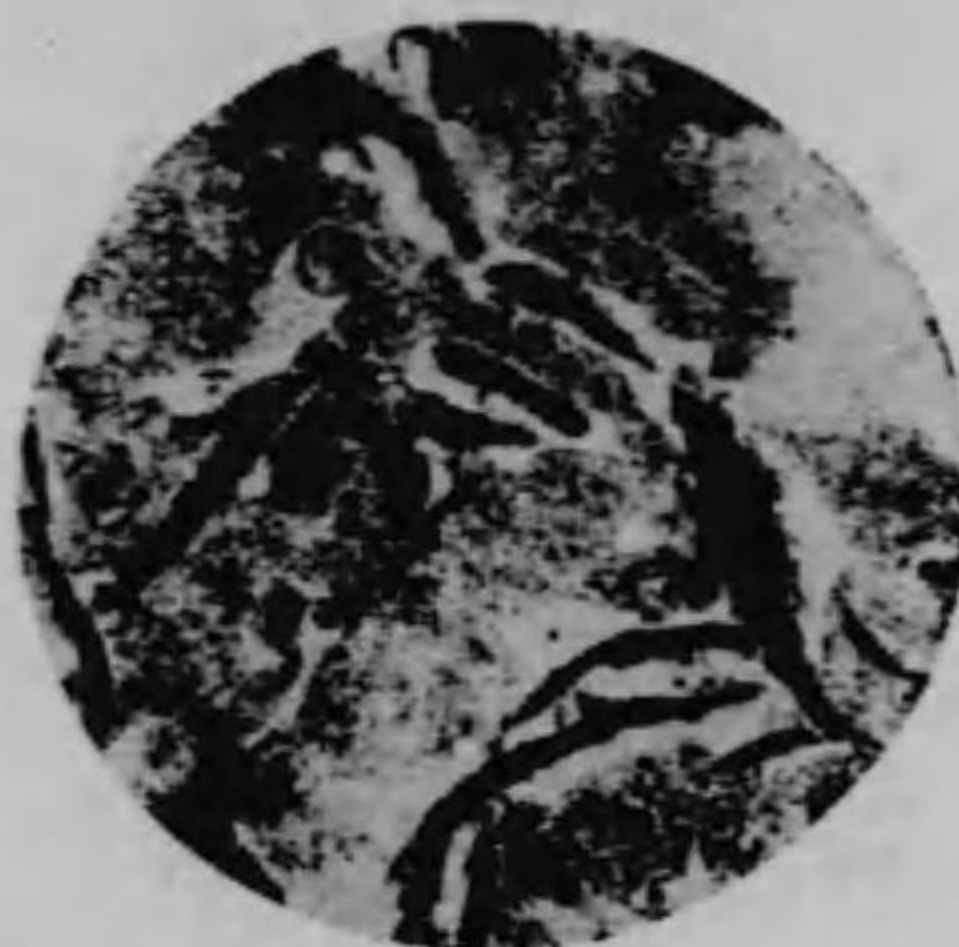
第九十一圖……「ハイポ、ユーテクトイド」の土臺を有せる鑄鐵 (73倍)
