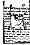
圖 16. 沈於液體中之物體所受之浮力等於其所排去之液體之證明
