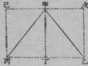
法先以底六尺折半得三尺爲勾。任以兩腰之一邊五尺爲弦。求得股四尺爲中垂線。與底六尺相乘。得二十四尺。折半得一十二尺。爲三角面積也。如圖甲乙丙三角形。以乙丙底邊與甲丁中垂線相乘。成戊乙丙己長方形積。比三角形積正大一倍。故折半得三角積也。
