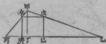
法先用求中垂線法。求得中垂線十二尺。與底邊四十四尺相加。得五十六尺。爲一率。中垂線十二尺爲二率。底邊四十四尺爲三率。推得四率九尺四寸二分八釐五豪有餘。卽三角形內所容正方之一邊也。如圖甲乙丙三角形。甲乙爲大腰。甲丙爲小腰。乙丙爲底。甲丁爲所得中垂線。戊己庚辛爲今所求內容
