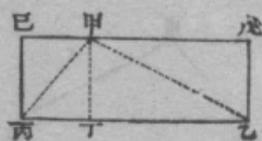
法先用求中垂線法。求得中垂線八尺。與底二十一尺相乘。得一百六十八尺。折半得八十四尺。為三角面積也。如圖甲乙丙三角形。先求甲丁垂線。既得甲丁垂線。乃與乙丙底邊相乘。成戊乙丙己長方形。比三角形積正大一倍。故折半得三角積也。
