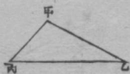
與甲乙邊與半總之較七尺相乘得二十一尺爲三率求得四率十二尺二十五寸開方得三尺五寸爲三角形自中心至三邊之垂線與三邊之總四十八尺相乘得一百六十八尺折半得八十四尺卽三角形之面積或以所得垂線三尺五寸與半總二十四尺相乘亦得八十四尺爲三角形之面積也此法蓋一率二率以線與線爲比三率四率以
