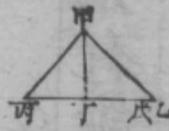
二十二尺。與小腰一百一十二尺相減。餘十尺。爲三率。求得四率十五尺六寸。爲底邊之較。與底一百五十尺相減。餘一百三十四尺四寸。折半得六十七尺二寸。爲勾。以小腰一百一十二尺爲弦。求得股八十九尺六寸。爲中垂線也。如圖甲乙丙三角形。甲乙爲大腰。甲丙爲小腰。乙丙爲底。甲丁爲所求中垂線。試以甲爲心。丙爲界。作一圓。截甲乙大腰。
