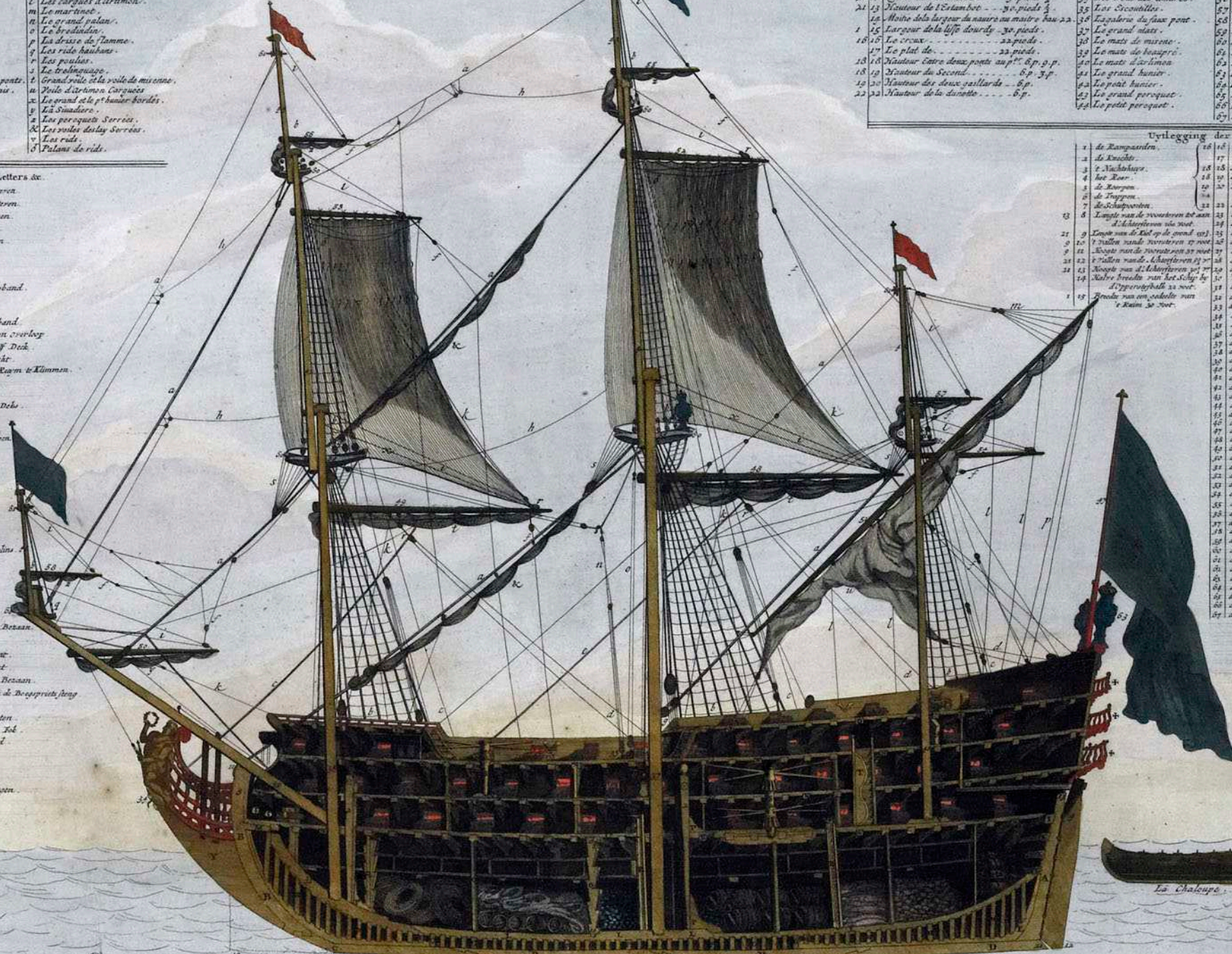
Coupe dun Amiral de 104. pieces de Canon avec ses principales proportions et les noms des pieces du dedans.
