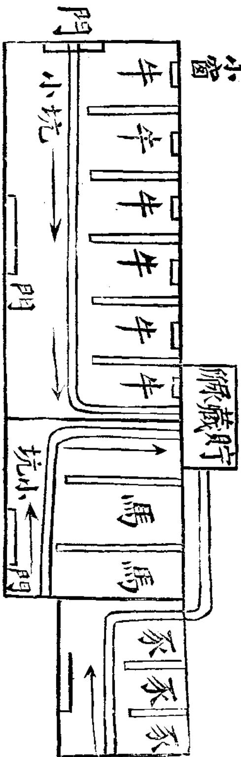
及運輸，牛馬房之內地，須有一定之斜度，即每畜頭之後方，宜築二尺深之小坑，以土敏土鋪好，直至棚外之牆下之尿液貯藏所，以作廐肥之用，藏尿窖宜極緊閉，不宜使雨水流入，或日光之直射，否則炭酸鎂受熱而蒸發，必有多量窒素之流亡。
