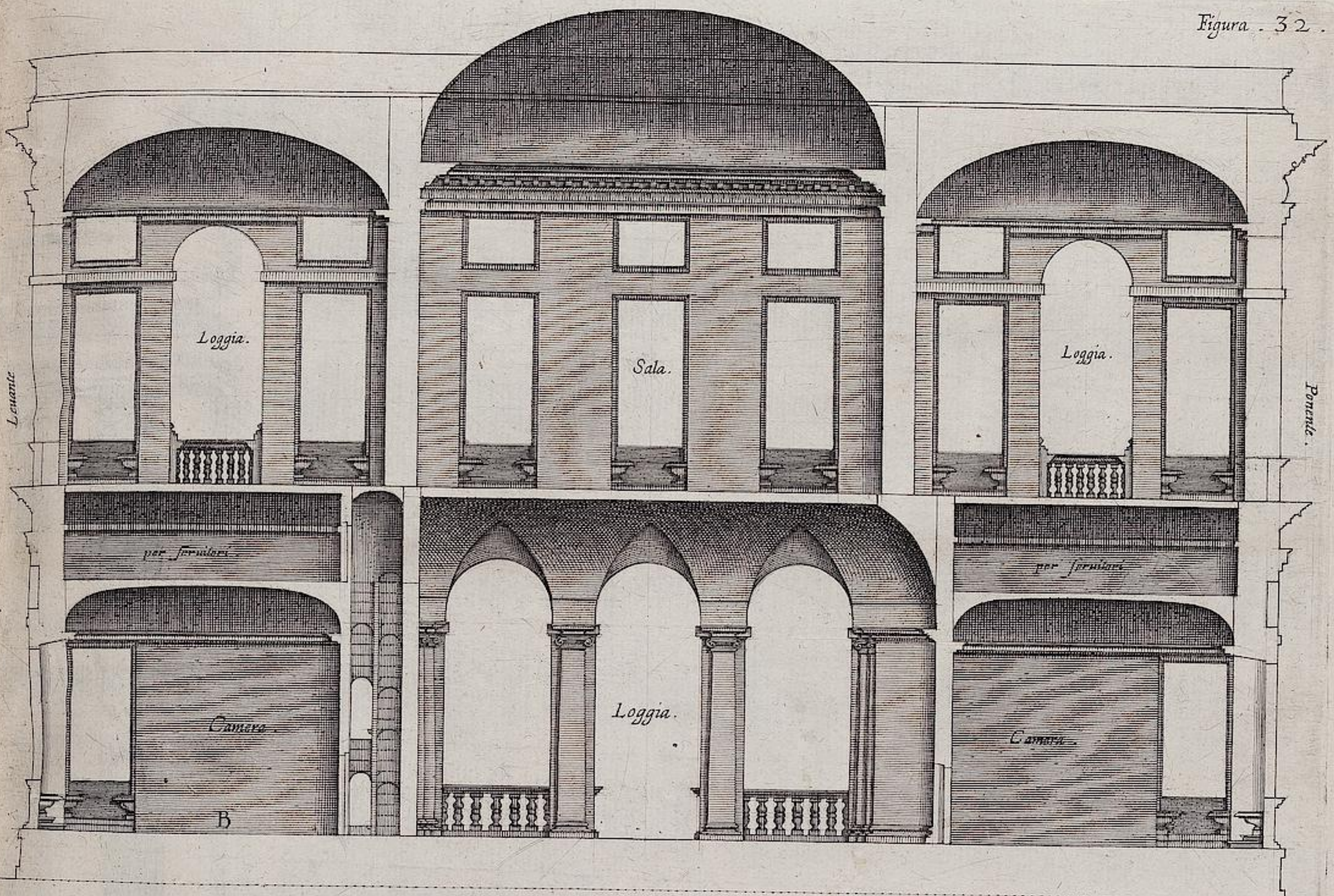
Taglio della parte anteriore del Palazzo . E . parallelo alla facciata levata sola la muraglia di quella .
