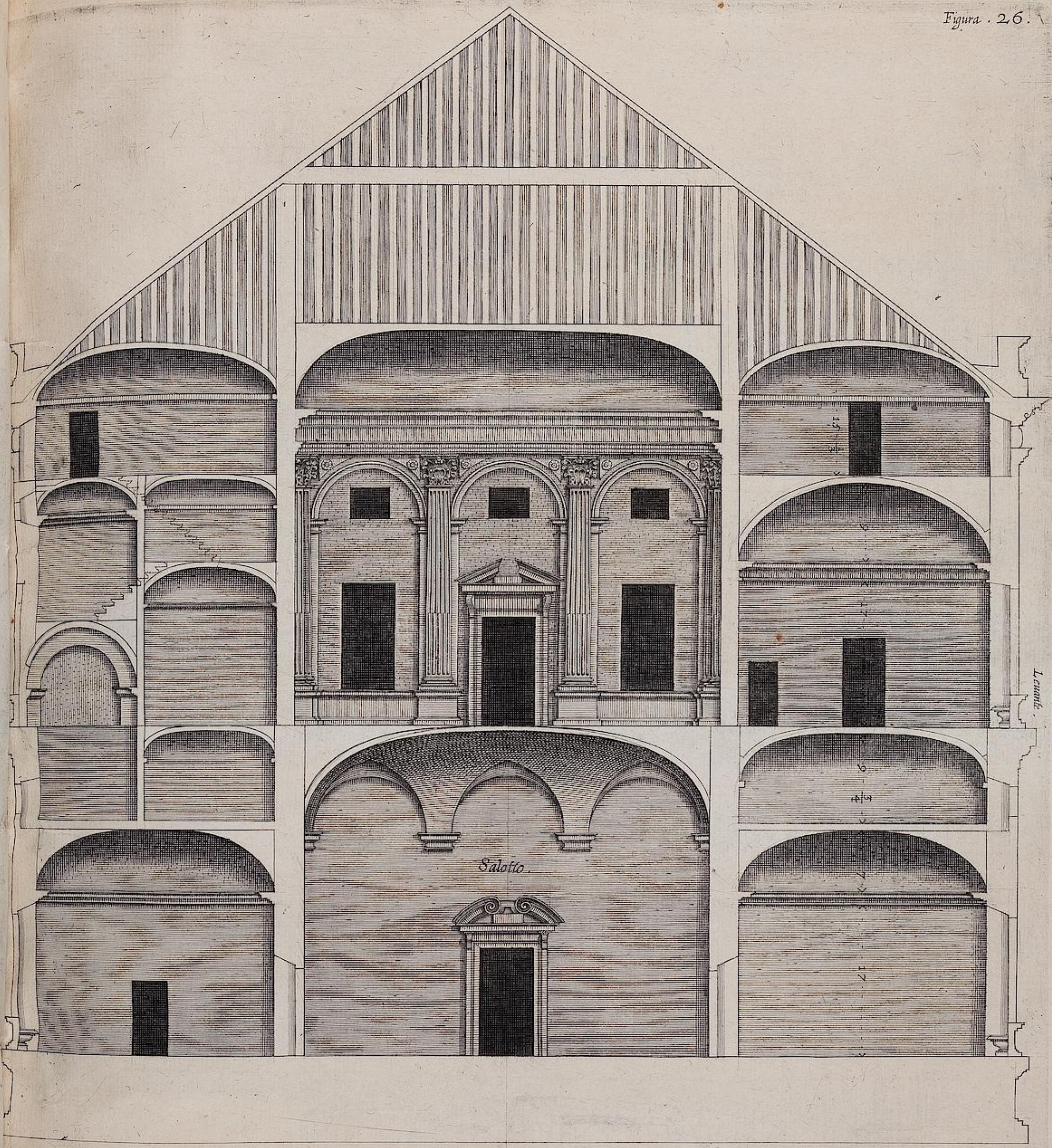
Taglio da ponente à levante mostrando la loggia oue è . contigua alla sala levata sola la muraglia del lato settentrionale del Palazzo . D.
