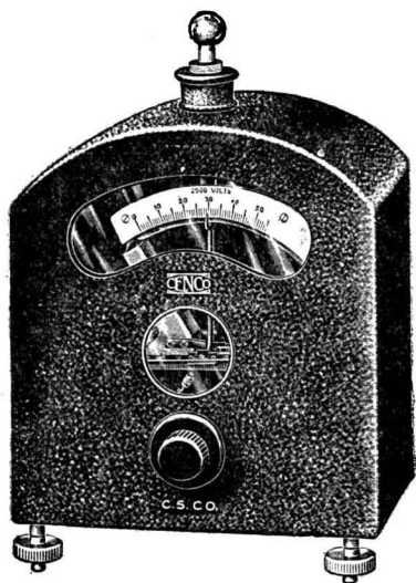
圖二七五 量度用精密之金箔驗電器。 可由望遠鏡觀測其內部金箔張開之角度。
