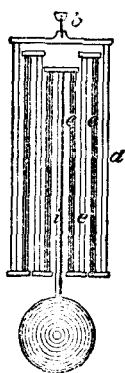
圖二一五 補償擺。 e 為銅棒，b, d, e 及 i 為鐵棒。 銅之膨脹係數，約為鐵之二倍以上，故若配合適宜，可使擺之全長一定不變。
