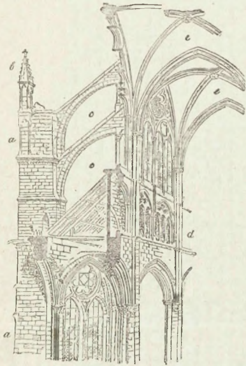
Рис. 2. Система готическихъ построекъ (Амьенскій соборъ). a —опорный столбъ; b —фіалъ; c —откосная подпорка; d —Трифориумъ; e —крестовый сводъ.
