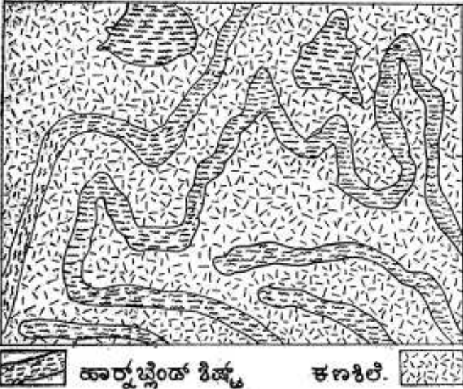
ಚಿತ್ರ 3. ಕೃಷ್ಣರಾಜಪೇಟೆಯ ಕೆರೆಯ ಕೋಡಿಯಲ್ಲಿ ಕಪ್ಪು ಹಾರ್ನ್ ಬ್ಲೆಂಡ್ ಪದರುಶಿಲೆ ಮತ್ತು ಕಣಶಿಲೆಗಳ ಸಮಾನಾಂತರವಾಗಿ ಮಡಿಕೆಗೊಂಡು ಪಟ್ಟಿ ಆಕೃತಿಯ (ಬ್ರಾಂಡೆಡ್) ನೈಸ್ ಆಗಿರುವುದು.
