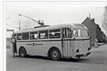
1940: Obus des Typs MPE 1 in Eberswalde, ausgestattet mit dem BBC-Einstangensystem
