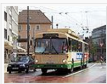
Markante Dachaufbauten beim Typ MAN SG 200 HO, der ansonsten auf dem Standard-Bus II basiert
