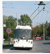
Luftweiche mit Fahrrichtungsanzeige
