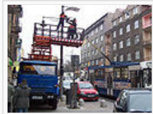
Gdynia: Turmwagen im Einsatz bei einer Stangenentgleisung
