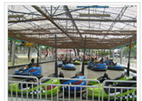
Auch Autoscooter sind nicht spurgeführte Fahrzeuge mit Stromabnehmer und Oberleitung
