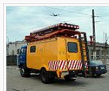
Die Wartung der Oberleitung verursacht Kosten, z. B. den Betrieb von Turmwagen
