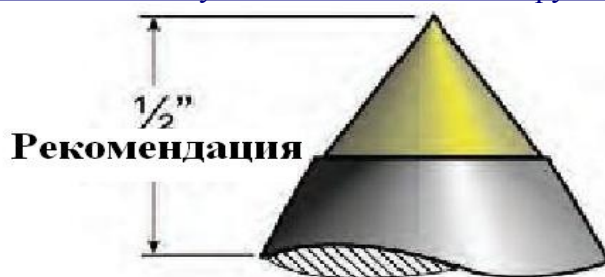
Фиг. 4-10. Образование пыли можно уменьшить за счёт конструкции зубьев рабочего органа ↑
