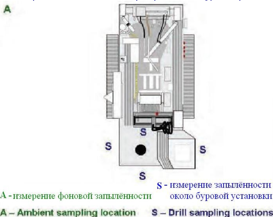
Фиг. 2-6. Положение измерителей запылённости при проведении буровых работ на поверхности ↑
