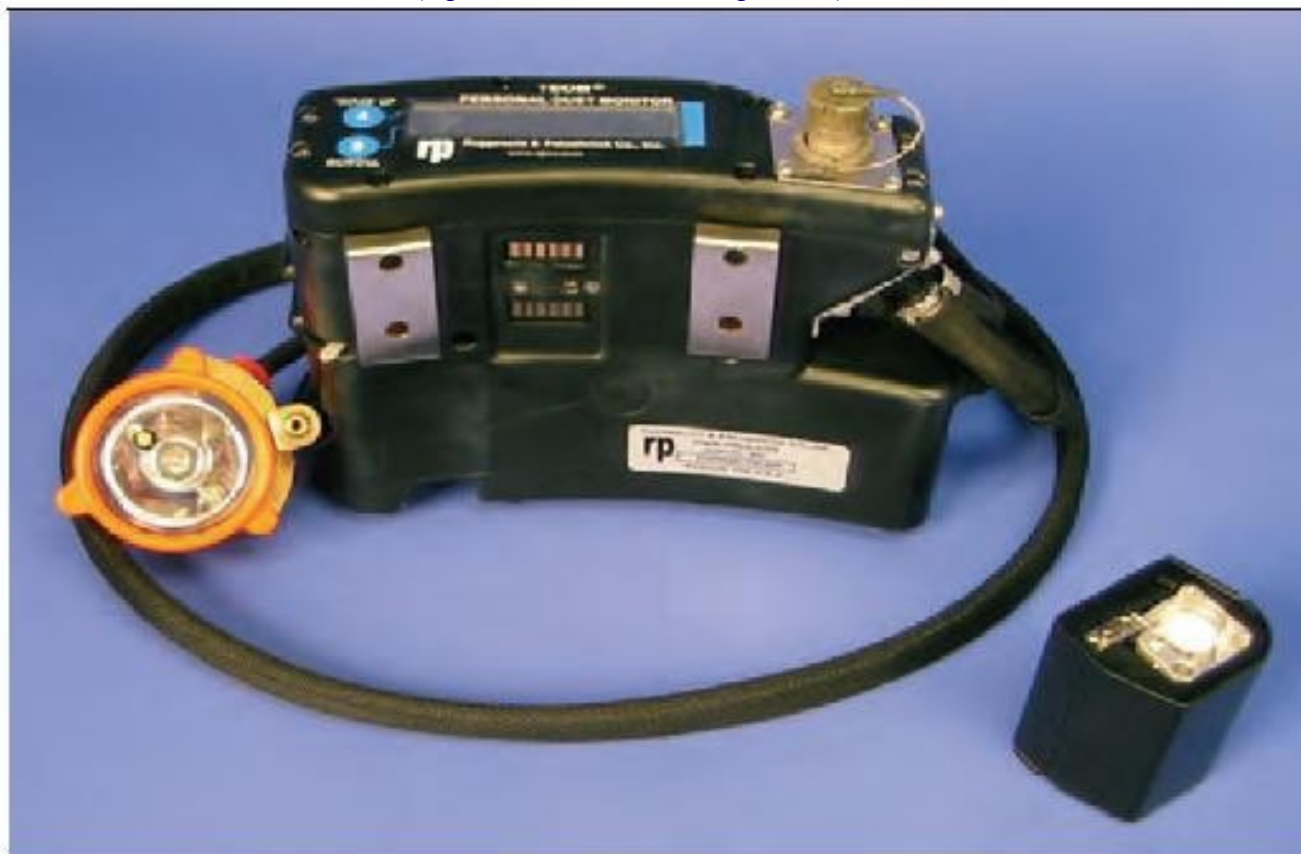
Фиг. 2-3. Индивидуальный измеритель - прибор PDM со снятым TEOM (в реальном масштабе времени) ↑
