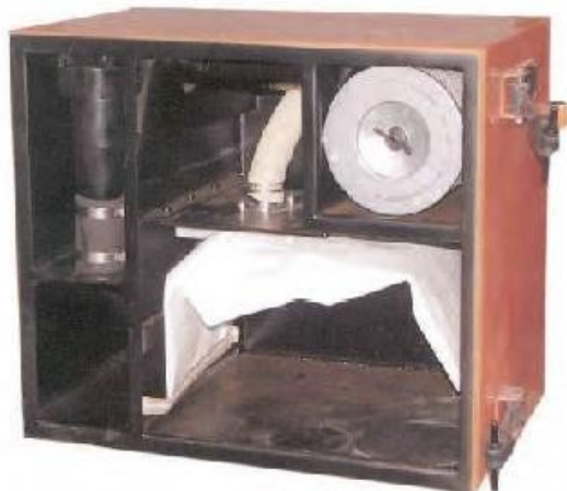
Фиг. 4-14. Бункер пылеуловителя с установленным мешком для пыли ↑
