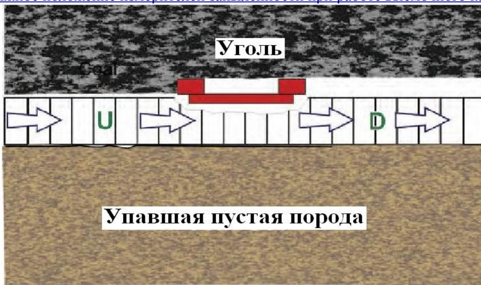
Фиг. 2-5. Подвижное положение измерителей запылённости при работе выемочного комбайна ↑
