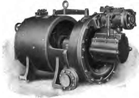
FIG. 124. 25-Kilowatt Curtis Turbine-Generator.
