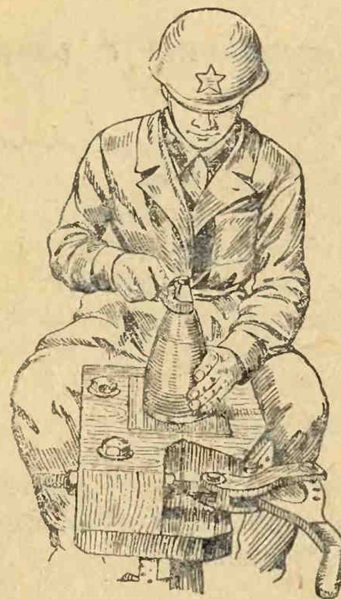
Рис. 172. Ввертывание взрывателей ключом (затяжка).
