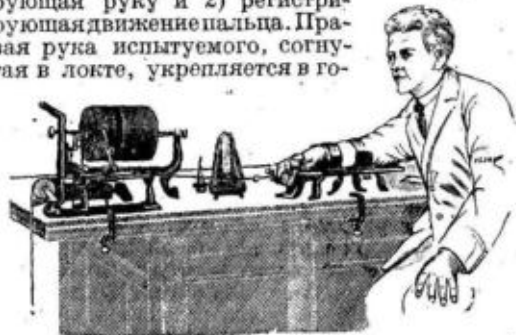
Рис. 1. Эргограф Моссю. Слева регистрирующий, справа—фиксирующий прибор. Запись эргограммы производится механически пером на законченной бумаге кимографа.
