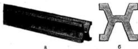
Рис. 1. а—Э. метра, вид сбоку; б—Э. метра в разрезе.
