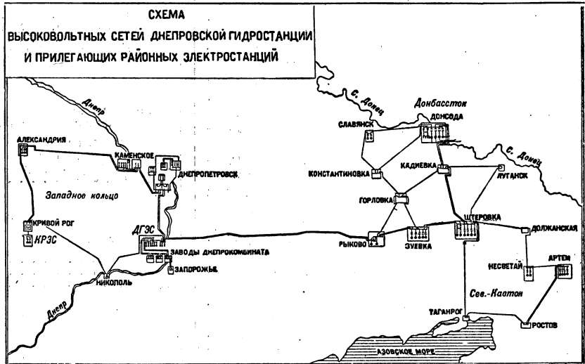
Рис. 9. Схема высоковольтных сетей ДГЭС и прилегающих электростанций.
