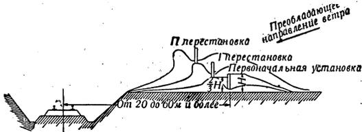
ж.-д. полотна. С. з. сооружаются в виде заборов (постоянных, временных и переносных) или же путём искусственного насаждения живых изгородей. Наиболее распространённым видом С. з. являются переносные решетчатые щиты, устанавливаемые до наступления зимы в 20—35 м вдоль ограждаемого ими пути так, что образуется забор; по мере отложения возле этого забора снегового вала, необходим своеобразный перенос щитов на вершину вала.
