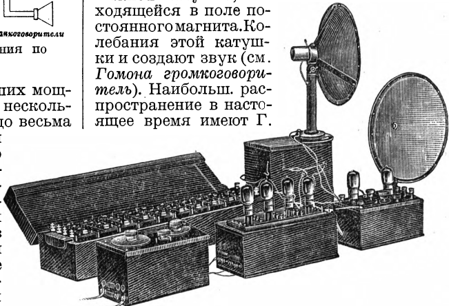
Рис. 4. Установка для громкоговорящего радиоприема с двумя комнатными репродукторами (типа ДП) треста «Электросвязь».
