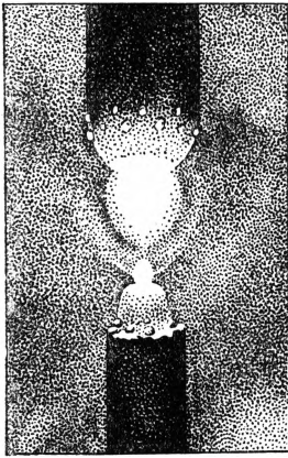
Рис. 1. Вид вольтовой дуги с угольными электродами.
