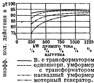
Рис. 1. Зависимость к.п.д. умформеров от нагрузки.
