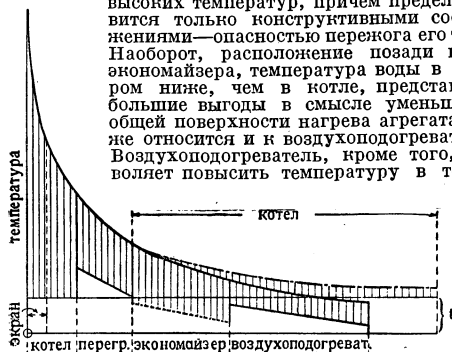
Рис. 19. Рабочая характеристика котла.
