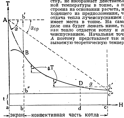
Рис. 18. Рабочая характеристика котла.
