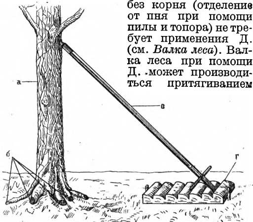
Рис. 1.—Древовал Вомана: а—сваливаемое дерево; б—подрубленные корни; в—жердь, толкающая дерево; г—укрепленная кольями доска для упора жерди.
