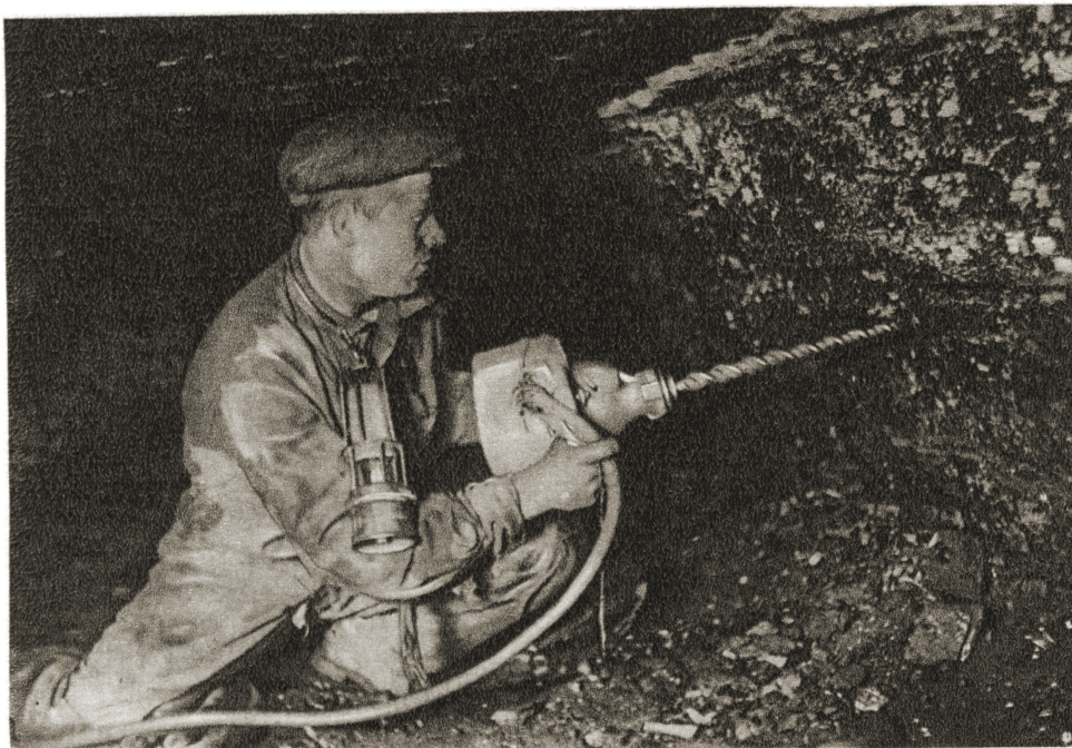
Механизированный забой. (Пневматическое бурение отверстий для закладки динамита).
