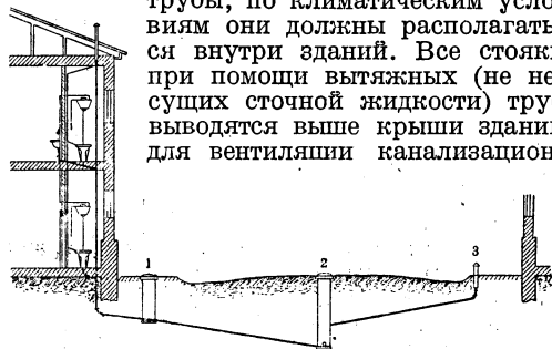
Рис. 4. 1—контрольный колодец, 2—смотровой колодец, 3—вентиляция.
