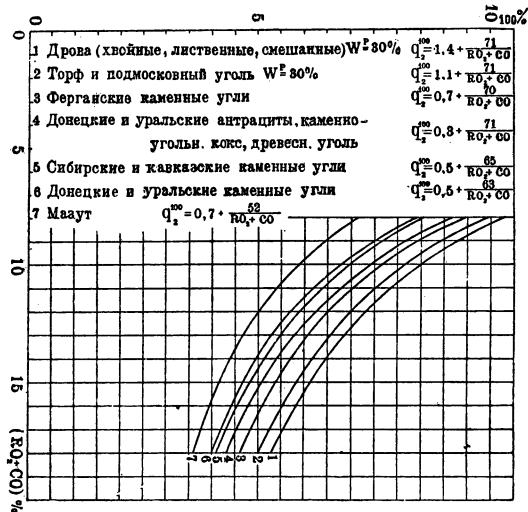
Рис. 6. Потеря тепла с уходящими газами в % от теплотворной способности основных топлив СССР.
