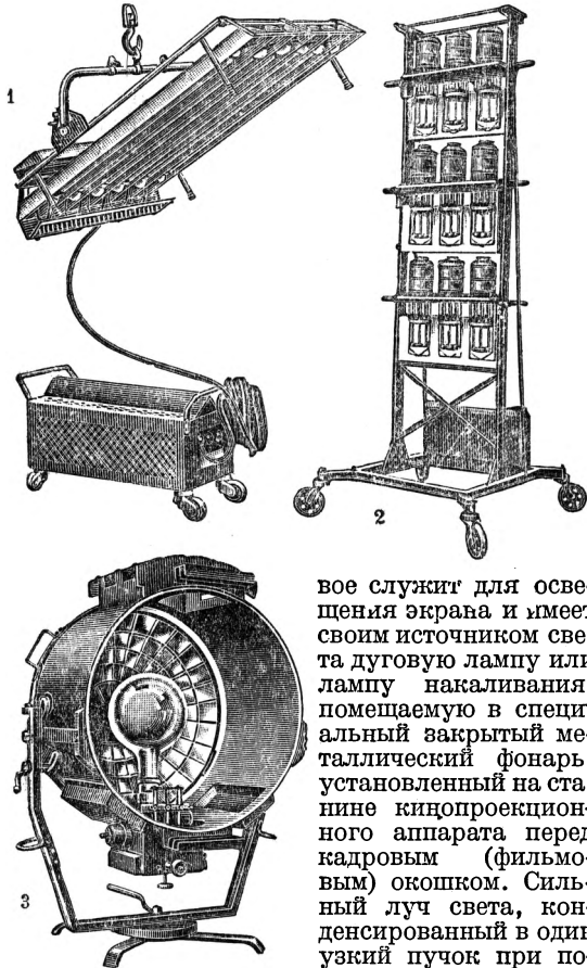
Рис. 9. Осветительная арматура для киносъемки: 1—ртутное освещение, 2—дуговой агрегат, 3—ауфгеллер—ламповый прожектор.
