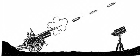
Рис. 6. Принцип работы баллистографа Дуда.
