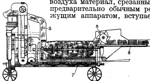
Рис. 9. Нэйшенал Фарм (разрез): 1—весы для зерна, 2—элеватор, 3—элеватор, 4—молотильная камера, 5—резец для перевалки, 6—питатель, 7—ковшечер для зерна.
