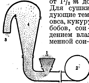
Рис. 2. Схема сушилки системы Лебедева: 1—загрузочная воронка, 2—вентилятор, нагревающий теплоноситель, 3—выход подсушенного продукта, 4—сушильный конус.
