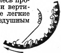
Рис. 2. Принцип работы триера.
