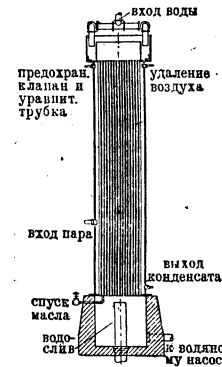
Рис. 8. Кожухо-трубчатый конденсатор.
