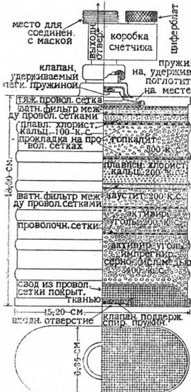
Рис. 5. Детали респираторной коробки противогаза «All-Service».
