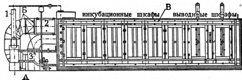
Рис. 5. Общий вид инкубатора «ИШС-16»: А—отопитель, Б—вентиляционная труба и коробка увлажнителя, В—камеры инкубатора.
