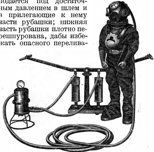
Рис. 1. Водолазное снаряжение с фильтром и с 2-цилиндровой помпой.
