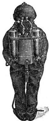
Рис. 3. Аппарат Дрегера с сжатым воздухом.
