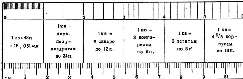
Рис. 4. Типографская система в сравнении с метрической (см).
