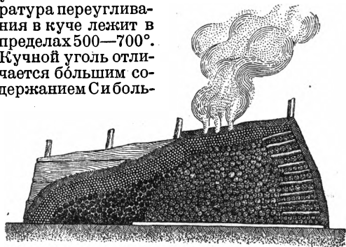
Рис. 2а. Лежащая куча для переугливания дерева.
