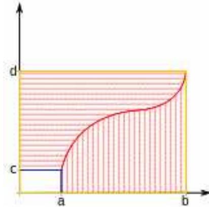
Funktionsgraph mit Umkehrfunktion und Flächen zur Berechnung eines Integrals der Umkehrfunktion.
