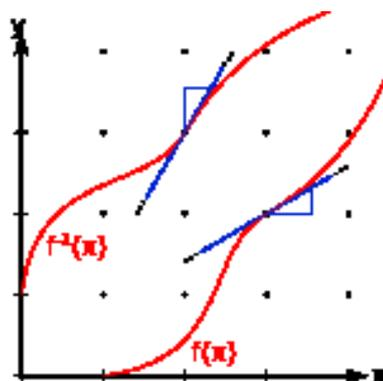
Eine Veranschaulichung für die Ableitung der Umkehrfunktion. Die Umkehrfunktion besitzt den an der Hauptdiagonalen gespiegelten Graphen und die Tangente wird mitgespiegelt.
