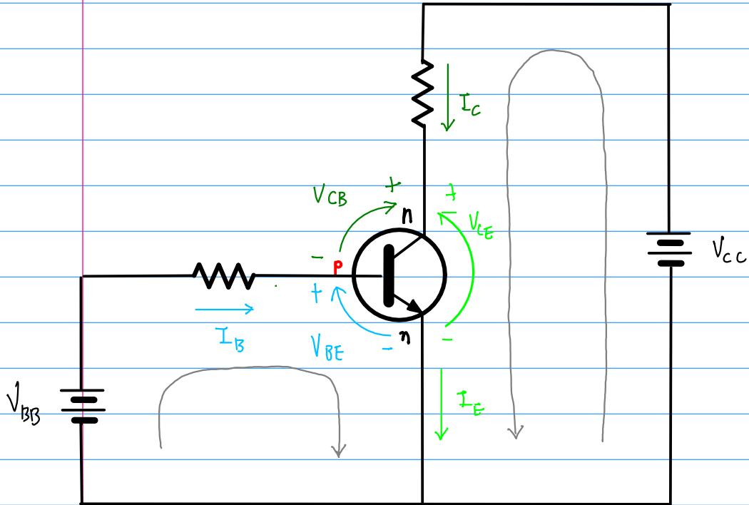
$$V_{BB} = I_B R_B + V_{BE}$$
