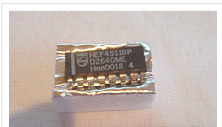
A CMOS 4000 IC in a DIP
