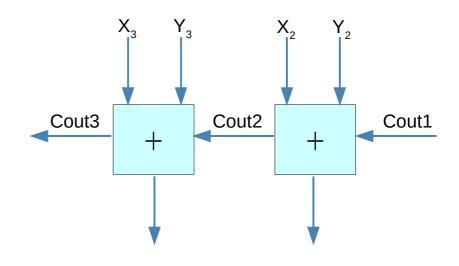
$$Cout_3 = (Cout_1 \cdot (C \, 1_3 \cdot C \, 1_2 + C \, 0_3 \cdot \overline{C} \, \overline{1_2})) + (\overline{Cout_1} \cdot (C \, 1_3 \cdot C \, 0_2 + C \, 0_3 \cdot \overline{C} \, \overline{0_2}))$$
