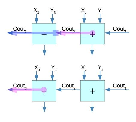
$$Cout_3 = (Cout_1 \cdot (C \, 1_3 \cdot C \, 1_2 + C \, 0_3 \cdot \overline{C} \, \overline{1_2})) + (\overline{Cout_1} \cdot (C \, 1_3 \cdot C \, 0_2 + C \, 0_3 \cdot \overline{C} \, \overline{0_2}))$$
