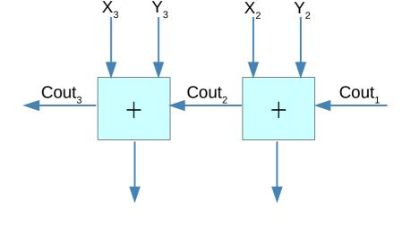
$$Cout_3 = (Cout_1 \cdot (C \, 1_3 \cdot C \, 1_2 + C \, 0_3 \cdot \overline{C} \, \overline{1_2})) + (\overline{Cout_1} \cdot (C \, 1_3 \cdot C \, 0_2 + C \, 0_3 \cdot \overline{C} \, \overline{0_2}))$$
